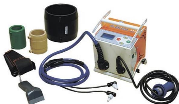
ELEKTRA 315 - это универсальный электромуфтовый аппарат для сварки электромуфт (ПЭ, ПП, напряжение сварки от 8 до 48 В). Встроенная память на 500 протоколов с возможностью передачи данных на ноутбук.
