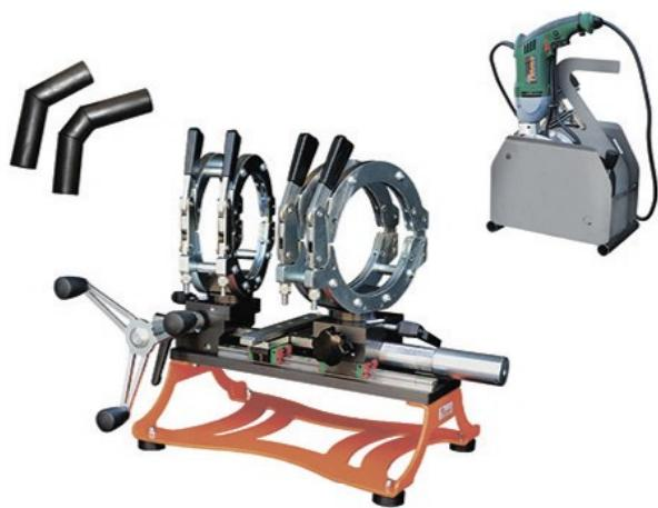
Портативная сварочная машина с механическим приводом для сварки труб, а также изготовления сегментных отводов диаметром до 160 мм. Незаменима в стесненных условиях при монтажных работах. Используя специальные зажимы, можно легко приваривать различные фитинги и буртовые втулки под фланец.
