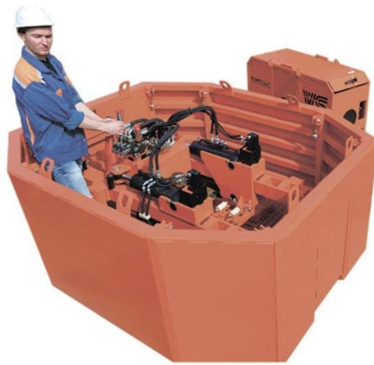
Мощная установка с тяговым усилием 125 тонн для бестраншейной прокладки трубопроводов Ø500мм или замены изношенных трубопроводов на новые с сохранением или увеличением диаметра и пропускной способности в городской застройке.
