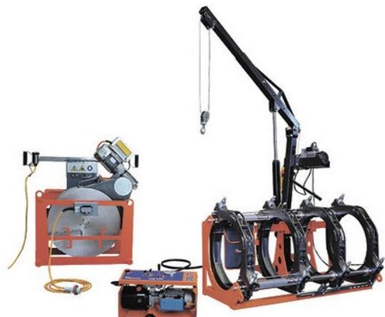
Стыковые сварочные аппараты для сварки трубопроводов газа, воды и других жидкостей под высоким давлением. Аппараты имеют возможность сваривать прямые отрезки трубы, а также приваривать к трубе колено, Т, Х, Y-образные фитинги и буртовую втулку под фланец без вспомогательного оборудования путем фиксирования свободного зажима с подвижными зажимами.
