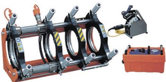
Стыковые сварочные аппараты для сварки трубопроводов газа, воды и других жидкостей под высоким давлением. Аппараты имеют возможность сваривать прямые отрезки трубы, а также приваривать к трубе колена, Т, Х, Y-образные фитинги и буртовую втулку под фланец без вспомогательного оборудования путем фиксирования свободного зажима с подвижными зажимами.
