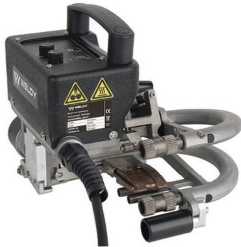
Сварочный аппарат горячего клина для сварки типичных геомембран (ПЭНД, ПЭВД, ТРО, ФРО и т. д.) При толщине материала 0,5-2,0 мм (ПЭНД 0,4-1,0 мм, ТРО 0,7-2,0 мм) для использования в рыбоводстве, для водных бассейнов, садоводства, гидроизоляция фундамента, при строительстве автомобильных дорог, искусственных водоемов, резервуаров и т. д.
