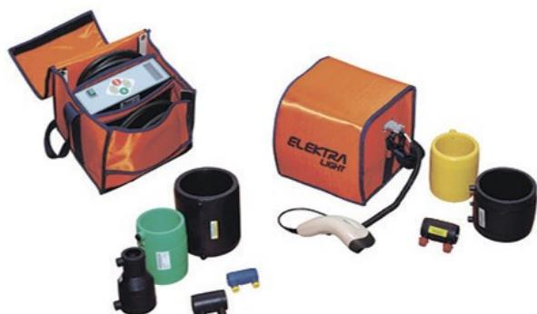
ELEKTRA LIGHT - это универсальный электромуфтовый аппарат для сварки электромуфт (ПЭ, ПП, напряжение сварки от 8 до 48 В). Поставляется с ручным сканером. Возможно подключение к принтеру, ПК (встроенная память на 300 сварочных циклов). Рабочие диапазоны: Ø20-160 мм
