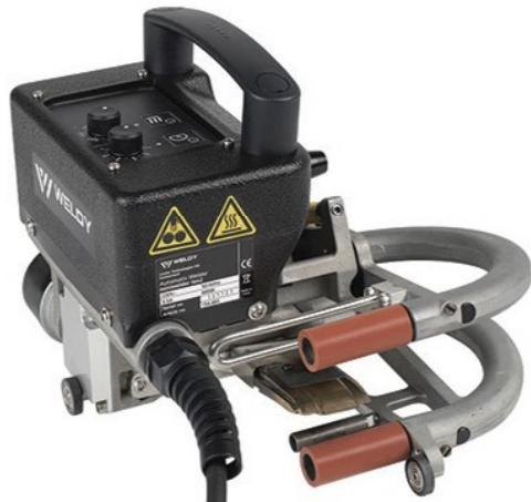
Сварочный аппарат горячего клина. Применяется для сваривания пленки, технической ткани и тонких мембран толщиной 0,3-1,5 мм. Свариваемые материалы ПЭВД, ПВХ, ПЭНД, ПП, ЭВА. Запуск сварочного процесса происходит легко благодаря улучшенной системе управления пленкой. Эксплуатация аппарата очень проста и интуитивна.
