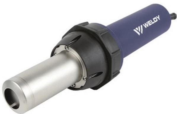
Многоцелевой и мощный ручной аппарат горячего воздуха для применения в разных сферах. Является идеальным инструментом для высокопроизводительной работы с пластиком. Тепловая мощность 3400 Вт может быть легко и бесступенчато отрегулирована и может использоваться для крупномасштабной усадки, гибки, нагрева и сушки с соответствующими насадками.
